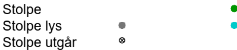
Figur 4: Utklipp fra tegningsforklaring i situasjonsplan - de ulike stolpetypene: nye, med og uten lys, samt de som fjernes.
