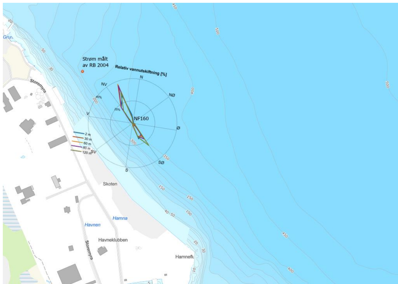
Figur 8-3 Vatnutskiftingsrose (NF160) ved 2 m (blå), 30 m (rød), 60 m (gul), 80 m (lilla) og 120 m (grøn) djup utanfor Mongstad. Målepunktet til Rådgivande Biologer er markert.
