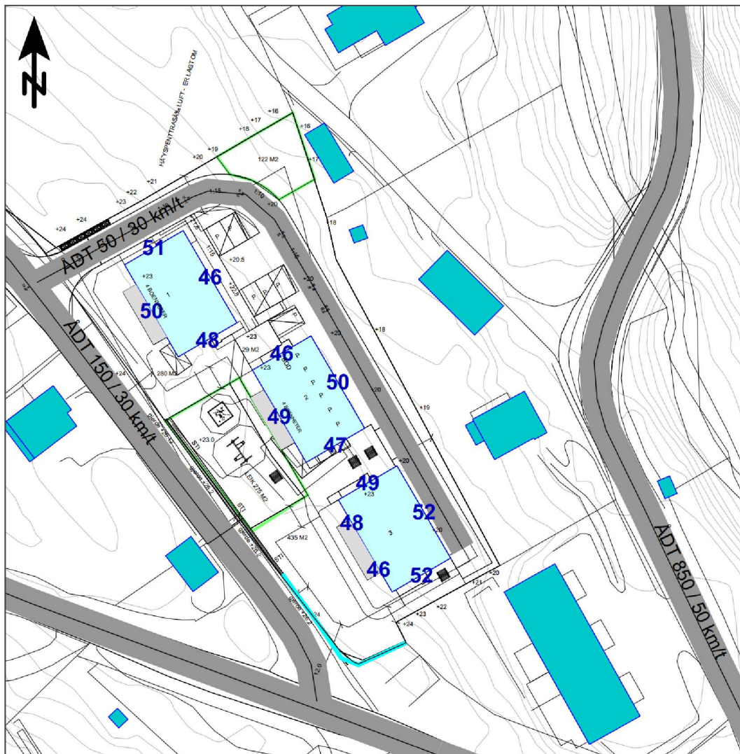
FIGUR 6 Punktberegning av utendørs støynivå L_{den} for 1. etasje.
