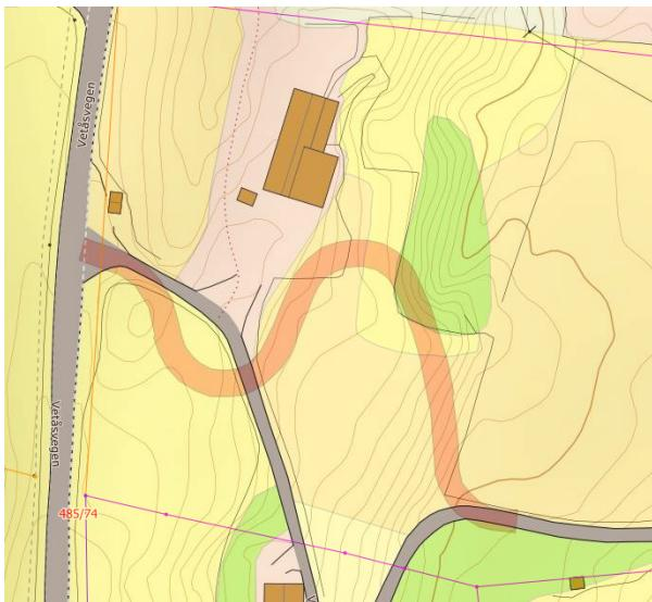
Situasjonsplan viser at to svingar skal erstattast den gamle vegen. Det er ikkje mogleg å utbeta eksisterande veg på grunn av bygningar og stigning gjennom tunet på gbnr 485/9 ( biletet under)
