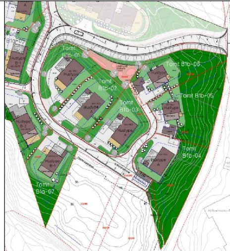
Figur 8 Utklipp utomhusplan med prosjekterte avkjørsler. Det er prosjektert 4 avkjørsler til feltet, altså 2 nye i forhold til regulert antall.
