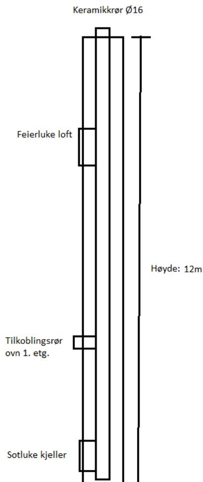
Det blir brukt schiedel keramikkrøyr ø16cm med avstandsholdere som blir senket ned i pipen. I kjellaren blir det montert sotluke. I 1. etasje blir det montert tilkoblingrør for omn der den eksisterende ovnen står. På loftet settes det inn ein feierluke for feiing av pipen. I toppen av pipen blir det montert en toppavdekning med regnkave og den eksisterende Skiferhatten blir gjenbrukt. Det blir montert en omn i stuen etter pipen er rehabilitert.
