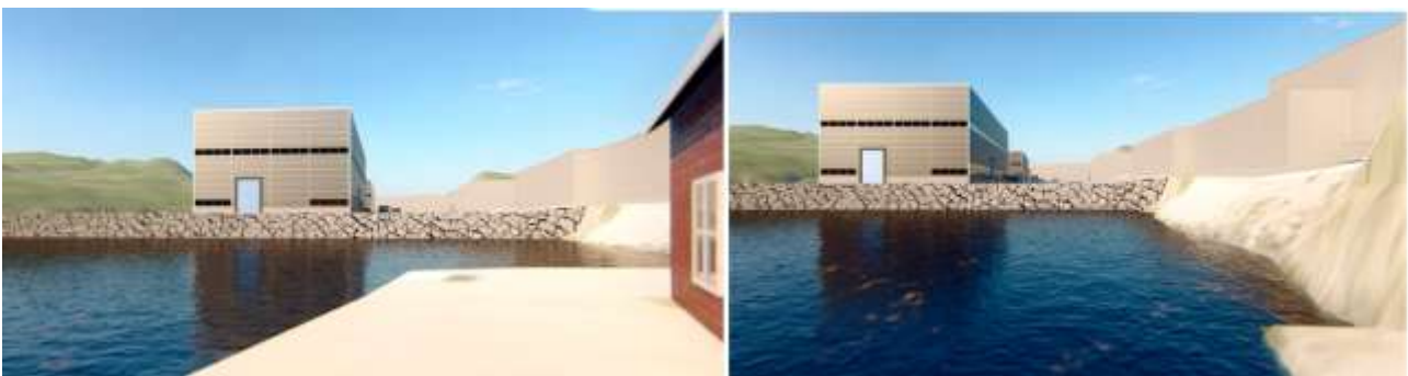
Figur 6-20 Fylling i sjø og planlagt nybygg sett fra Flatøy kai. Bildet til høyre viser forholdet til eksisterende bygning. Gesimshøyden på det nye bygget blir ca. 2 meter lavere enn eksisterende bygning i nord. Ill: Multiconsult
