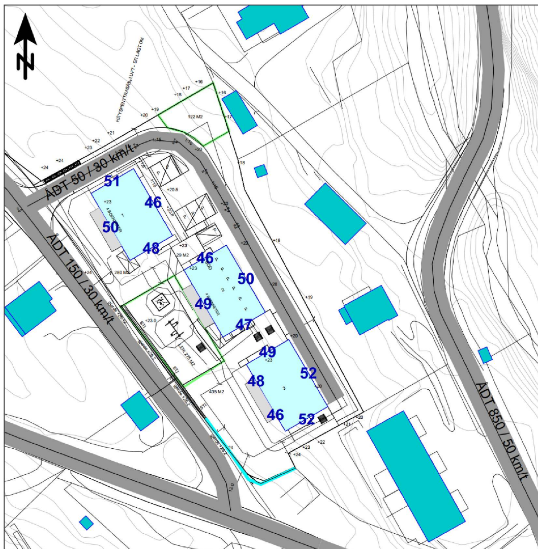
FIGUR 6 Punktberegning av utendørs støynivå L_{den} for 1. etasje.
