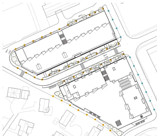
Armatur Glamox: O41 LED 4500 HF 830 WB BL (venstre) O55-250 LED 3000 HF 830 WBA BLACK (høyre)
