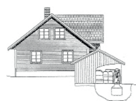
FD 5 Std. Nedgravd mottakstank under garasje/anneks
