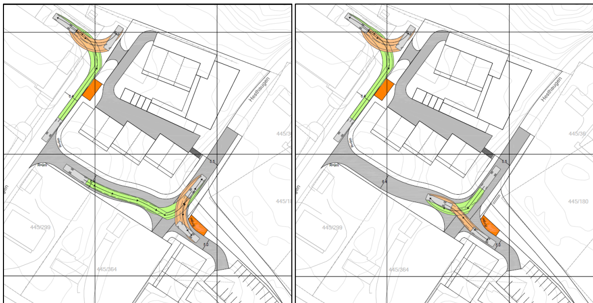
Figur 2 Figuren viser to alternative sporingskurver for lastebil på 11 meter.
