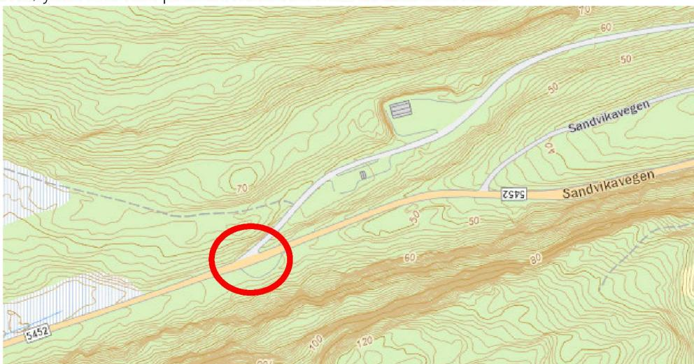
3. Siktkrava for avkøyrsla er 6 x 105 meter. Det vil sei at ein 6 meter inn frå veggkanten skal ha frisikt 105 meter i kvar retning frå dette punktet. Det kan ikkje vere sikthinder i siktsona høgare enn 0,5 meter.
