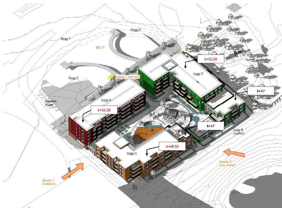
Figur 2: 3D-illustrasjon av forslag ved gitt dispensasjon. Rød tekst avviker gjeldende plan
