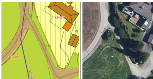
Figur 1 Kart som viser planlagt veg og ortofoto som viser situasjon i dag. Vegen vert flytta nokre meter inn på teigen
