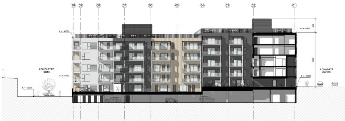
Figur 6: Snitt mot nordvest, som viser planlagt kjeller og terreng etter gjennomført tiltak.
