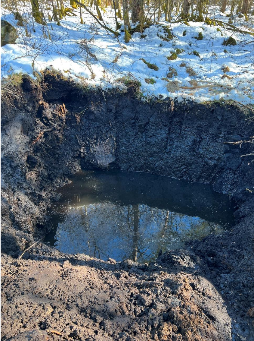
Figur 1 Myr på sørsiden av E39. Om lag 4-5 meter dyp.
