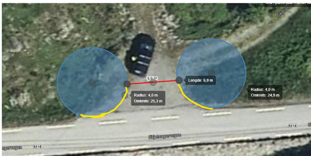
Figur 1: Utforming av avkjørsel.
