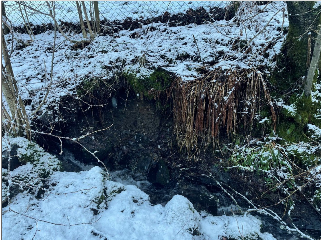
Figur 10: Nærbilde av løsmasser observert ved bekken øst for kartleggingsområdet. Løsmassene består av organisk materiale og sand, samt enkelte blokker i selve bekkeløpet. Bildet er tatt mot øst.
