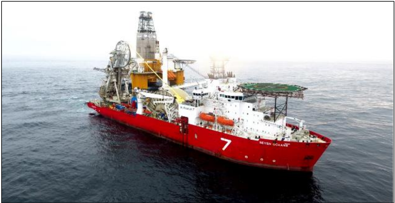
Figur 3. Bilde av spesialskip for legging av rørledning.
