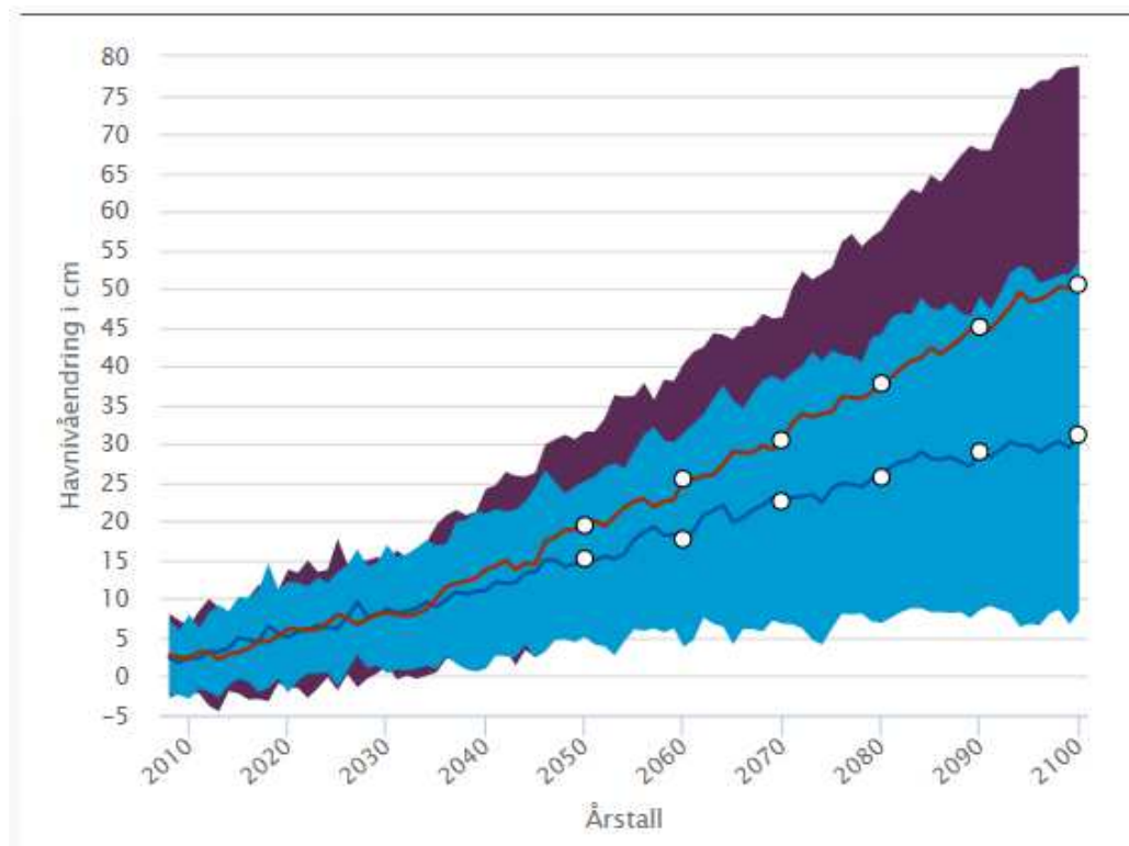
Figur 20 syner endringar i havnivå for Osterøy fram til år 2100. Scenario for redusert utslepp er synt med blått og høgt utsleppsnivå er synt med lilla (Kjelde: NKSS, rapport 1/2015).
