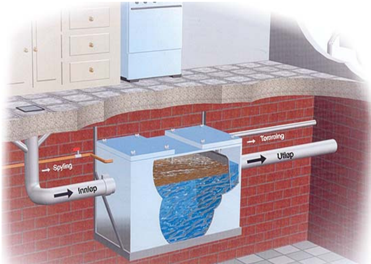
Prinsippskisse fettutskiljar under golv
