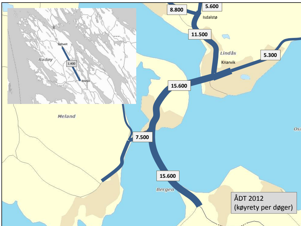
FIGUR 15. TRAFIKKMENGDER, ÅDT PR. 2012.
