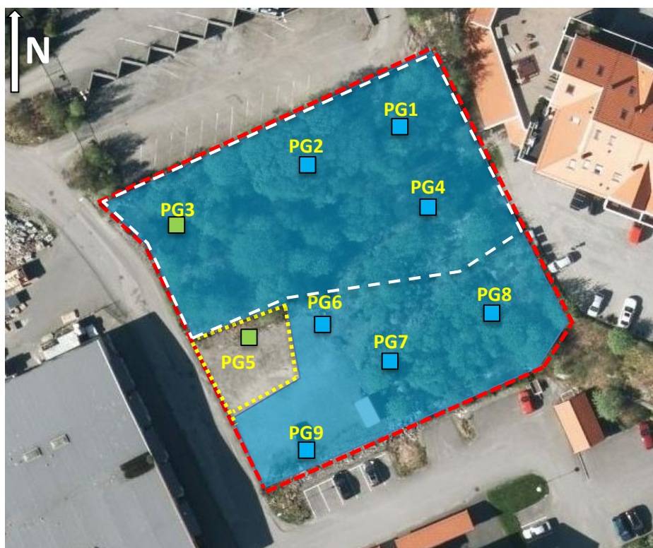
Figur 8-1: Tiltaksplan. Innenfor gul, stiplet linje skal forurensete masser fjernes ned til ca. 1,5 m under terreng. De dypereliggende massene er rene. Innenfor blåskravert område er løsmassene i utgangspunktet rene, men innenfor hvit, stiplet linje skal det tas supplerende prøver av dypereliggende masser dersom det her påtreffes andre typer masser enn det som ligger i de overflatenære massene. Rene masser kan disponeres fritt innenfor Plan- og bygningslovens bestemmelser. Sjøppl, teglstein, takstein o.l. skal sorteres ut. Forurensete masser skal leveres til godkjent mottak.
