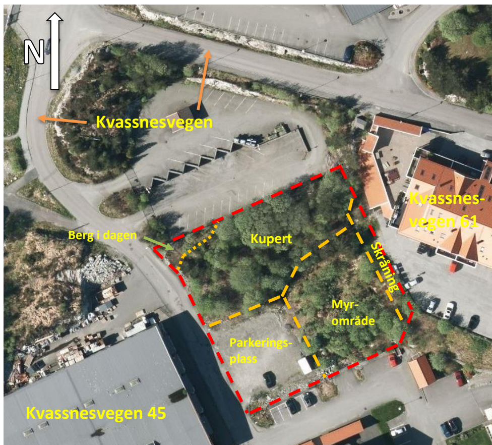
Figur 2-2: Oversiktsfoto. Tiltaksområdet er markert med rødstiplet linje. Området er inndelt i delområder etter areal og topografi (Kartgrunnlag: www.kartverket.no ).
