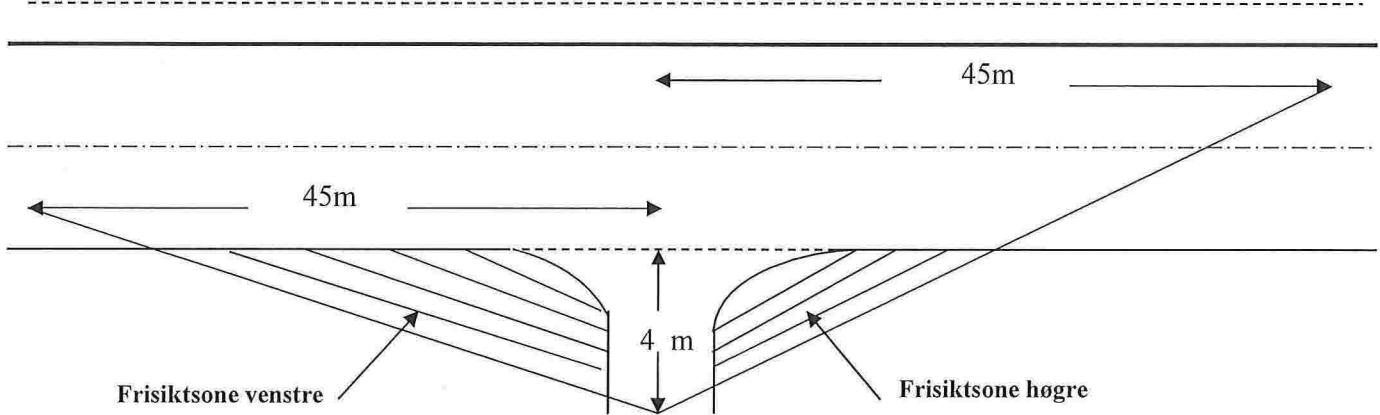
Tilsvarande sikt lengder som vist på tegningen må også gjerast gjeldande for trafikken som kjem på hovedvegen og skal inn i avkjørsla (sikt bakover og framover langs hovedvegen)
