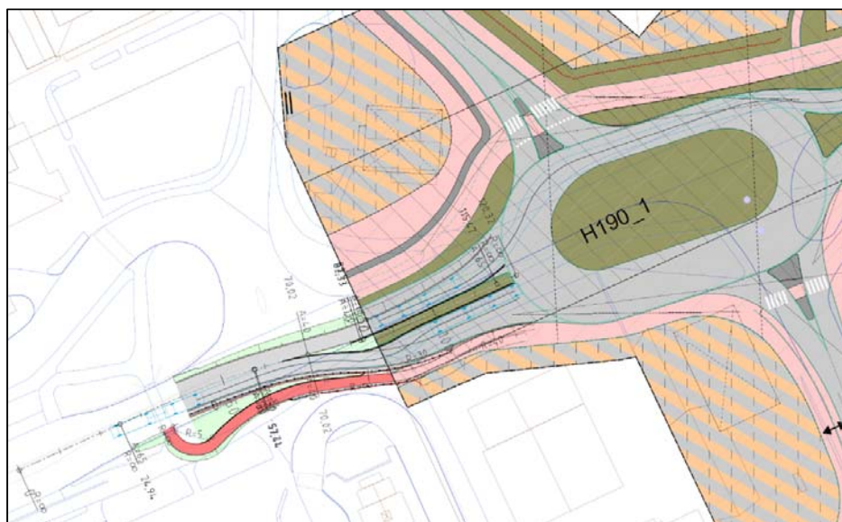
Figur 12 - E39 midlertidig tilpassing mellom eksisterande veg og ny rundkøyring
