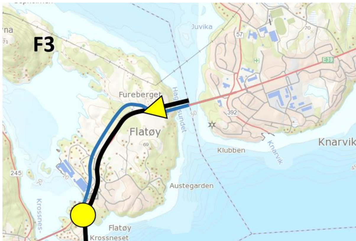
Figur 46 E39 frå Flatøy til Knarvik med parallelt lokalevegssystem og halvt kryss aust på Flatøy vist som prinsipp.
