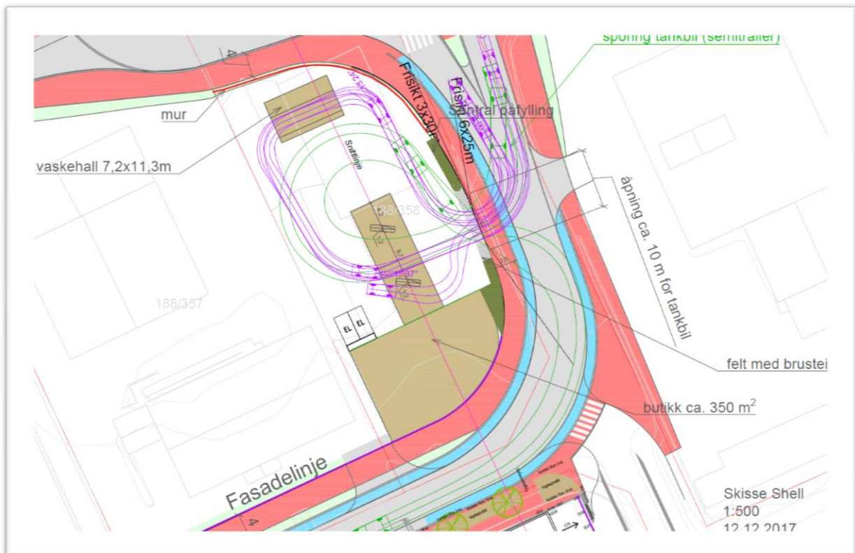
Figur 3: Illustrasjonen viser mulig kjøremønster for personbiler og tankbil (type semitrailer).
