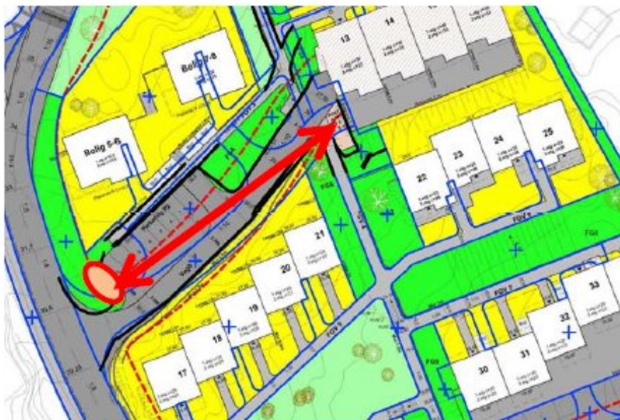
Fig 25. For mer praktisk avhenting av buss foreslår vi at tiltakshaver/ kommunen kan vurdere å etablere bussplassen (PS2) nærmere adkomstvegen for bussbil. Den alternative bussplassen kunne også være en sekundær bussplass, der større dunker med f.eks. papiravfall var samlet. Løsningen måtte da inngå i revidert utomhusplan og det kunne da vurderes å søke om dispensasjon fra gjeldende bebyggelsesplan.
