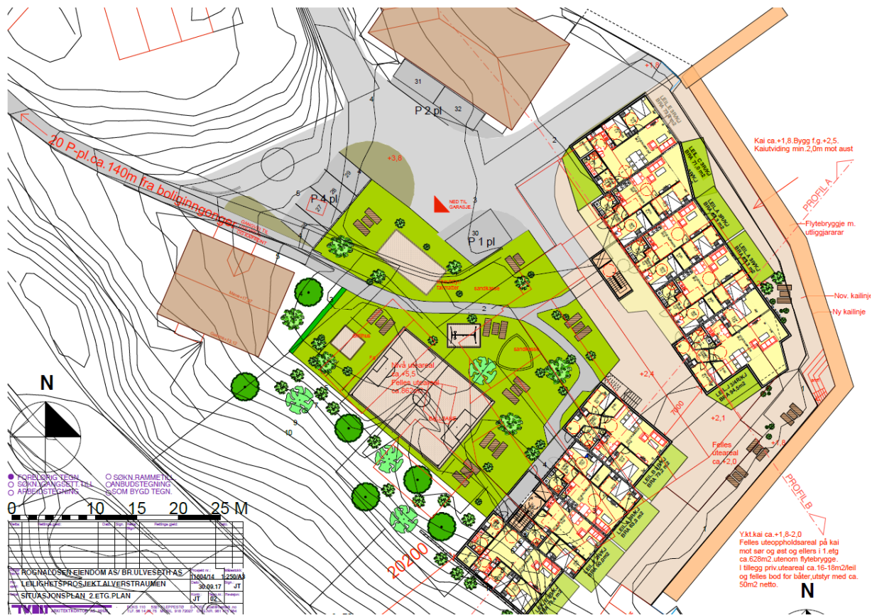
2. etasje med felles areal for lek og uteopphald og gangbru til trappehus i austre bygg
