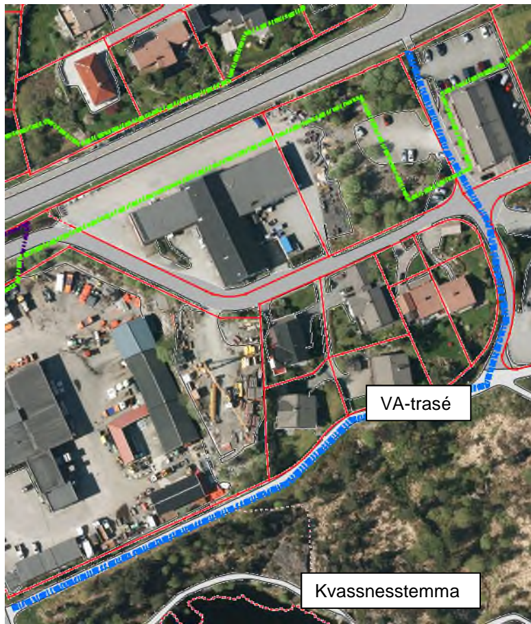
Figur 6. VA-arbeid i eksisterende tursti på nordsiden av Kvassnesstemma.
