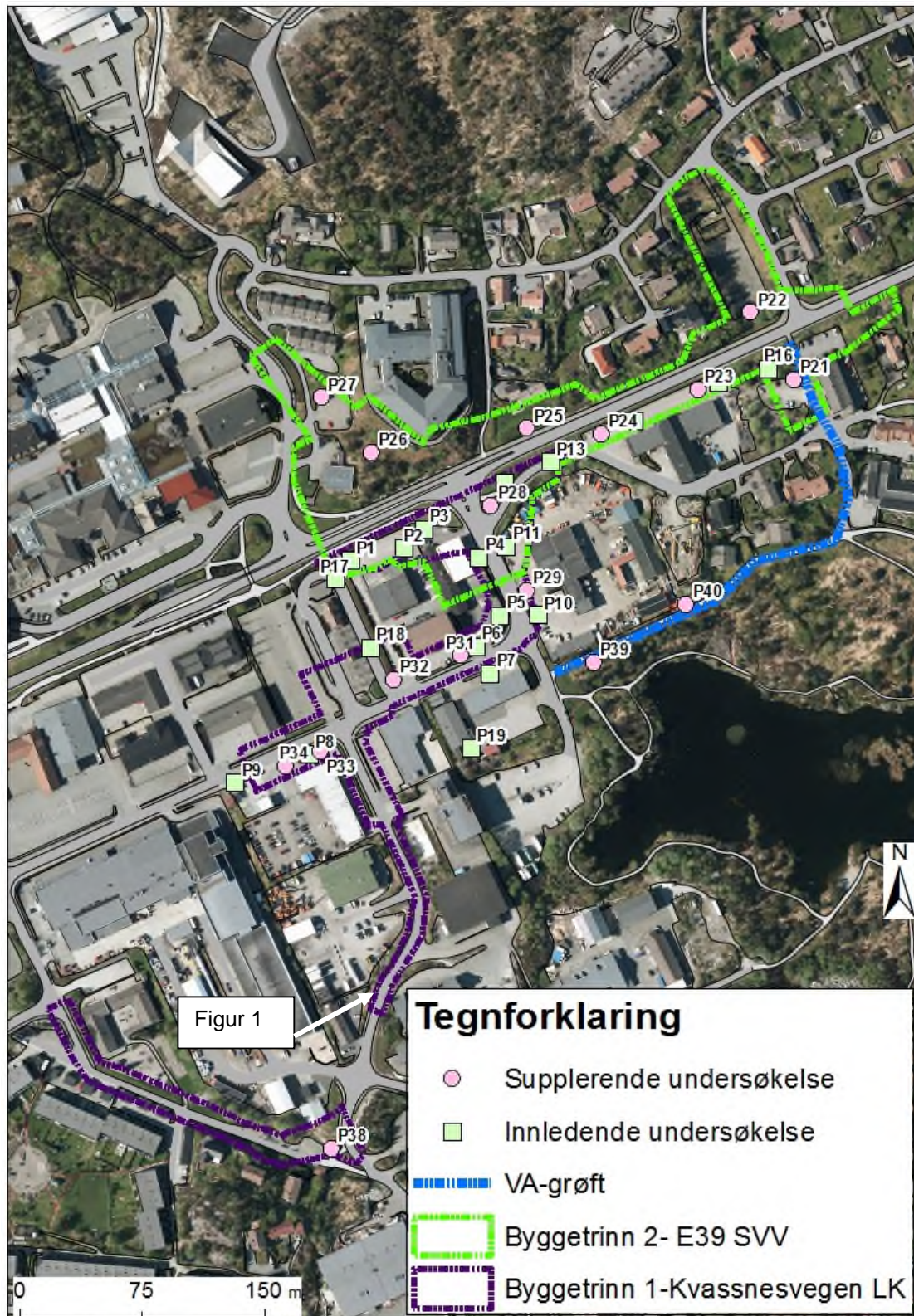
Figur 2. Byggetrinn 1 og 2 samt innledende og supplerende prøvepunkt fremgår av figuren. Bildet som er vist i Figur 1 er tatt i punkt angitt over.
