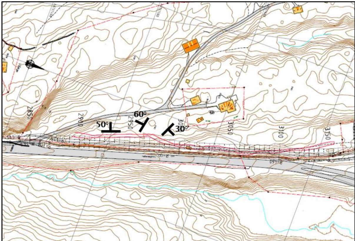
Figur 8: Utsnitt fra C005 med inntegnet hakesymboler viser sprekkesettene orientering i forhold til veglinjen
