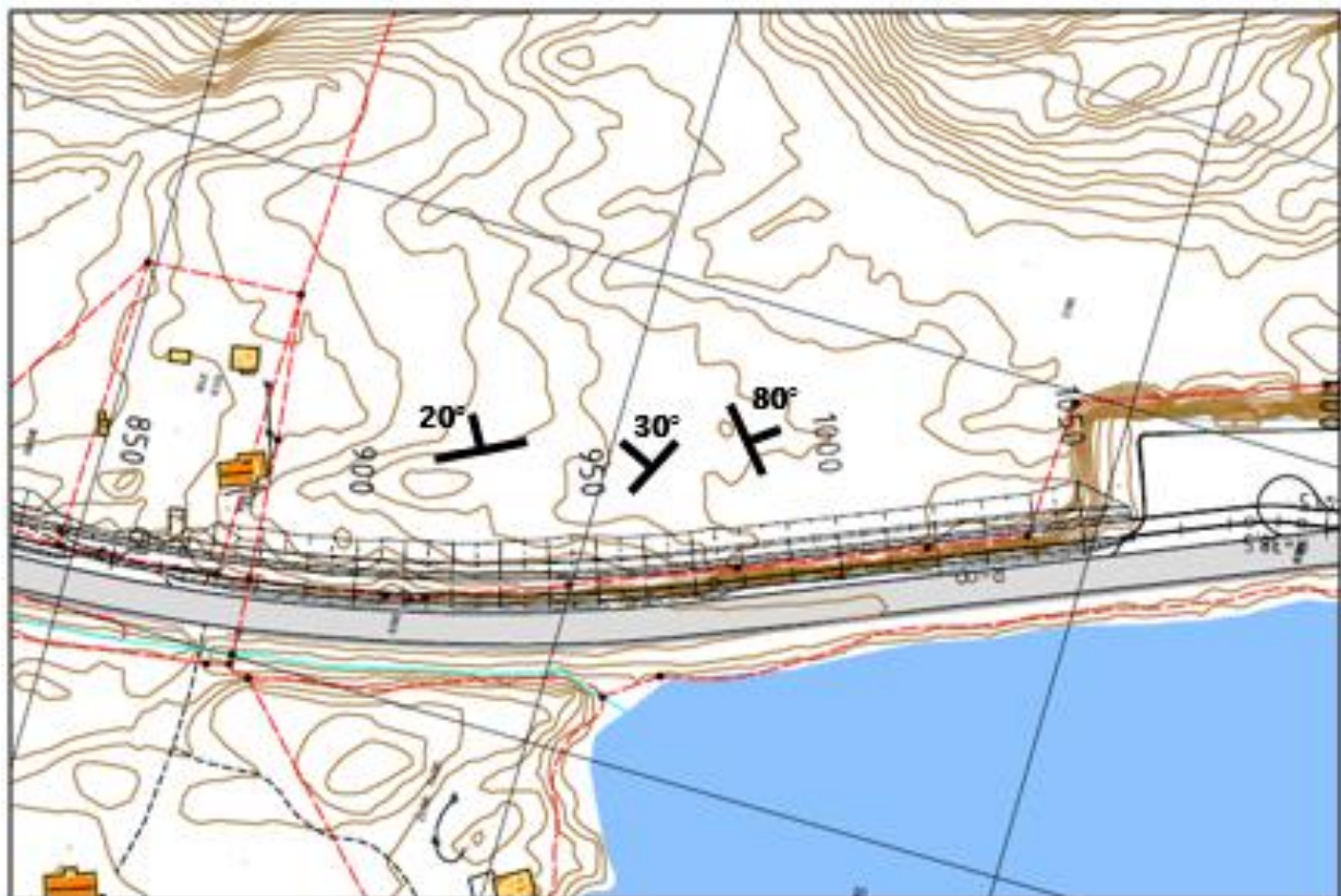
Figur 4: Utsnitt fra C002 med inntegnet hakesymboler som viser sprekkeseettene orientering i forhold til veglinjen.
