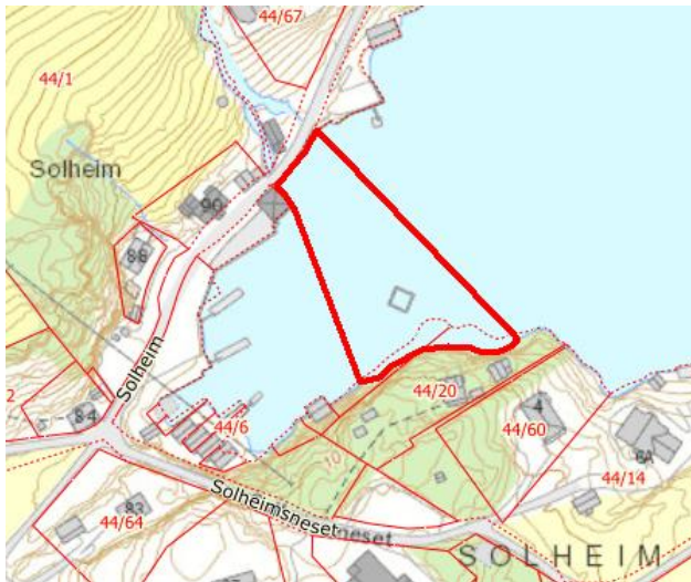
Figur 6. Anbefalt utforming for utviding av eksisterande område for småbåthamn. Storleik om lag 3 daa.
