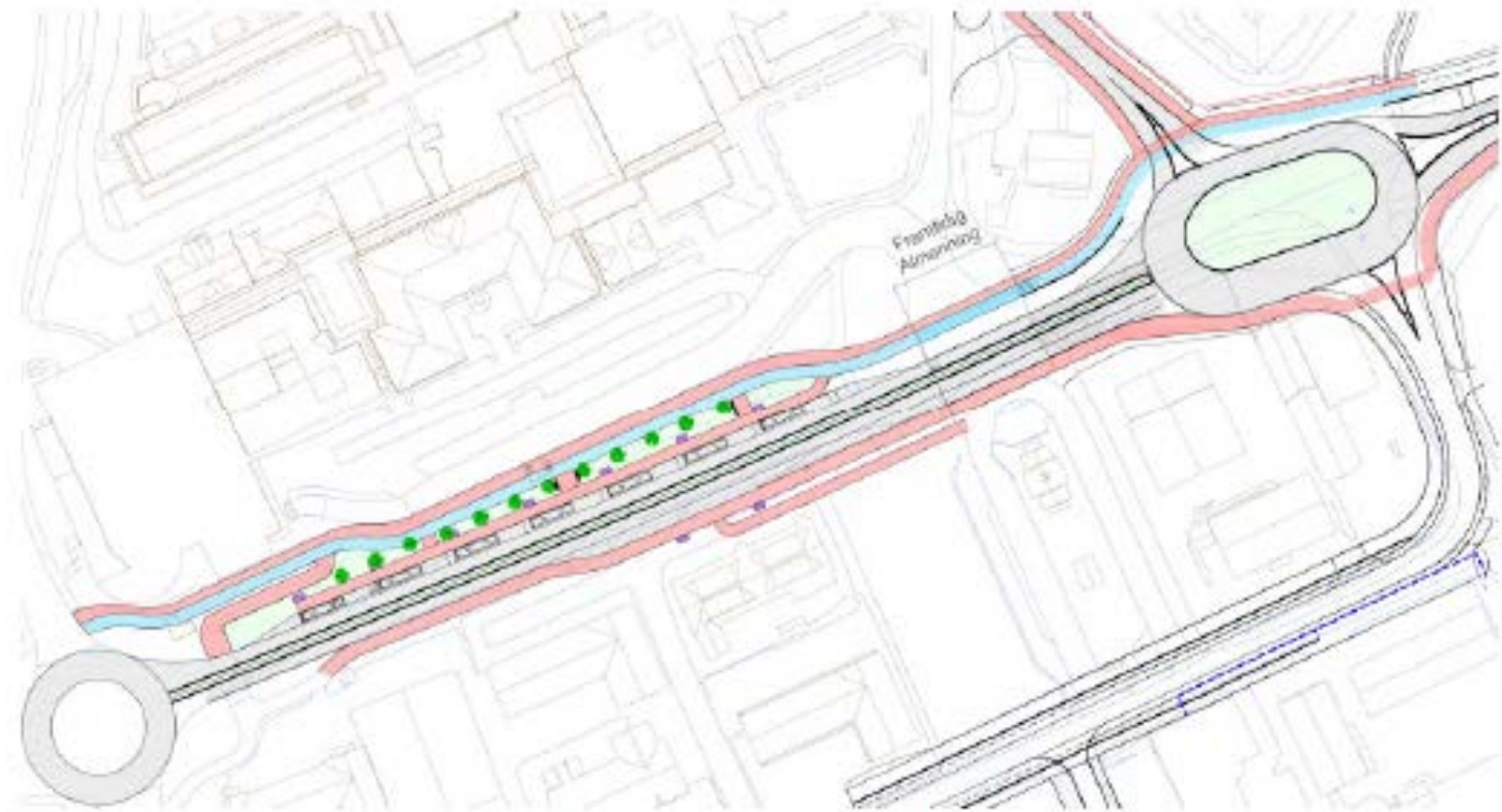
Fig. 9. Prinsippskisse for mulig framtidig løsning med gjennomgående GS-veg (fra tidlig fase, leskur og oppstilling endret senere)
