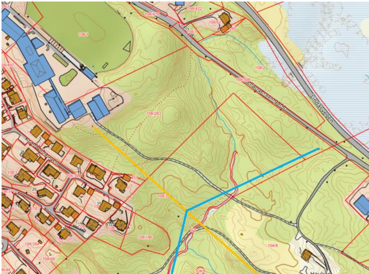
Figur 18: Kraftleidningar. Oransje 22 kv - høgspenn vil bli fjerna og lagt i kabel langs fv 398. Blå 22 kv - line vil bli ståande som luftspenn. Det er ønskeleg med ein kabel frå skulen fram til blå line for å sikre ringsamband.
