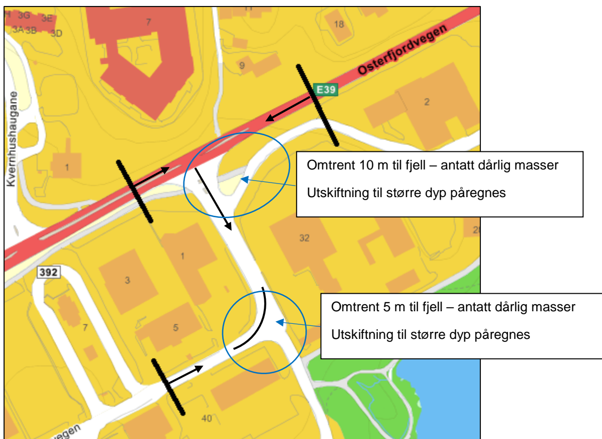
Figur 1. Fokusområdet for den siste supplerende miljøtekniske grunnundersøkelsen som ble gjennomført i mai 2018, vist med svarte piler. Større masseutskifting påregnes på deler av disse arealene. Resultater fra tidligere undersøkelser tyder på at området kan være forurensnet til større dyp, men forurensningen er ikke tidligere avgrenset i dybden.
