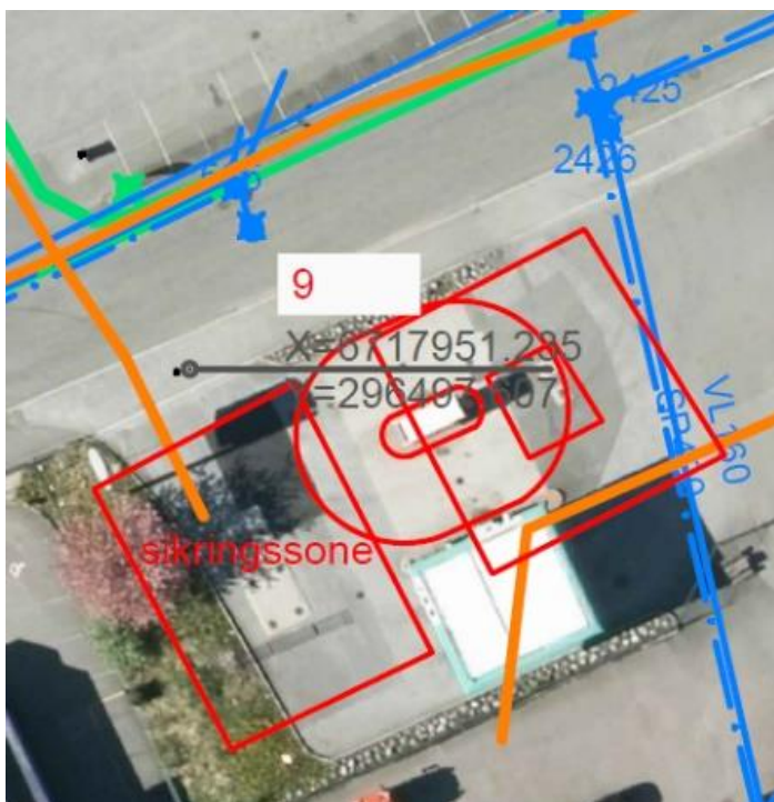
Figur 11. Sikringssoner og nedgravd infrastruktur ved bensinstasjon 1-2-3t. Plassering av P9 er vist over. Sikringssonene er det bensinstasjonene som stiller krav om.
