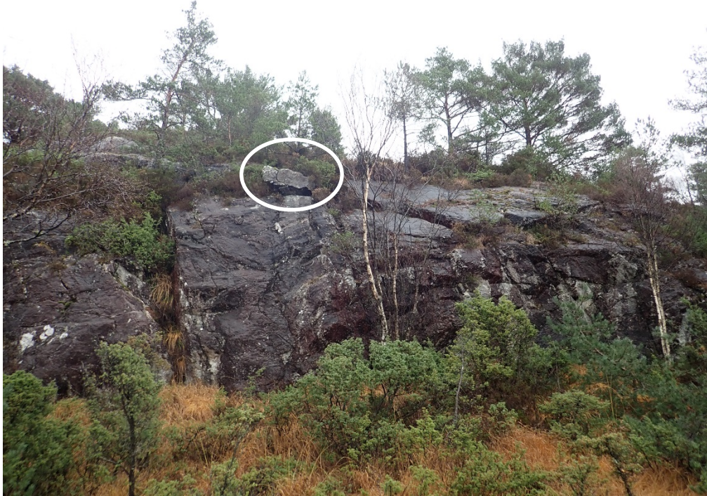
Bilde nr. 7. Vertikalt bergparti øst i planområdet. Avløst blokk på ca. 0,5 m 3 i toppkant av skråningen (omringet). Området er planlagt regulert til grøntstruktur.
