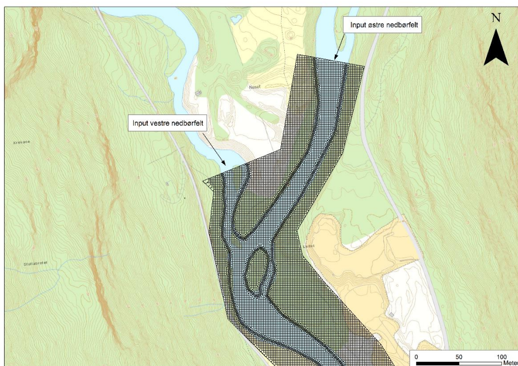
Figur 3-3 Oppstrøms ende av 2d-modellen ved samløp av de to delfeltene. Eikefetelvi.
