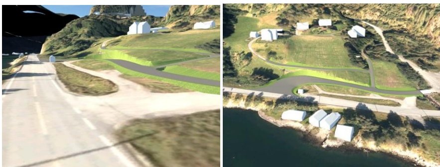
Figur 9-17: Til venstre: Ny avkøyrsla mot avfallsdeponiet i bakgrunnen. Eksisterande avkøyrsla i framgrunnen. Til høgre: Avkøyrsla sett frå vest.
