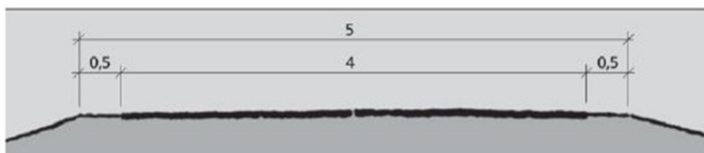
Figur C.21: Tverrprofil A1, 5 m vegbredde (mål i m)
