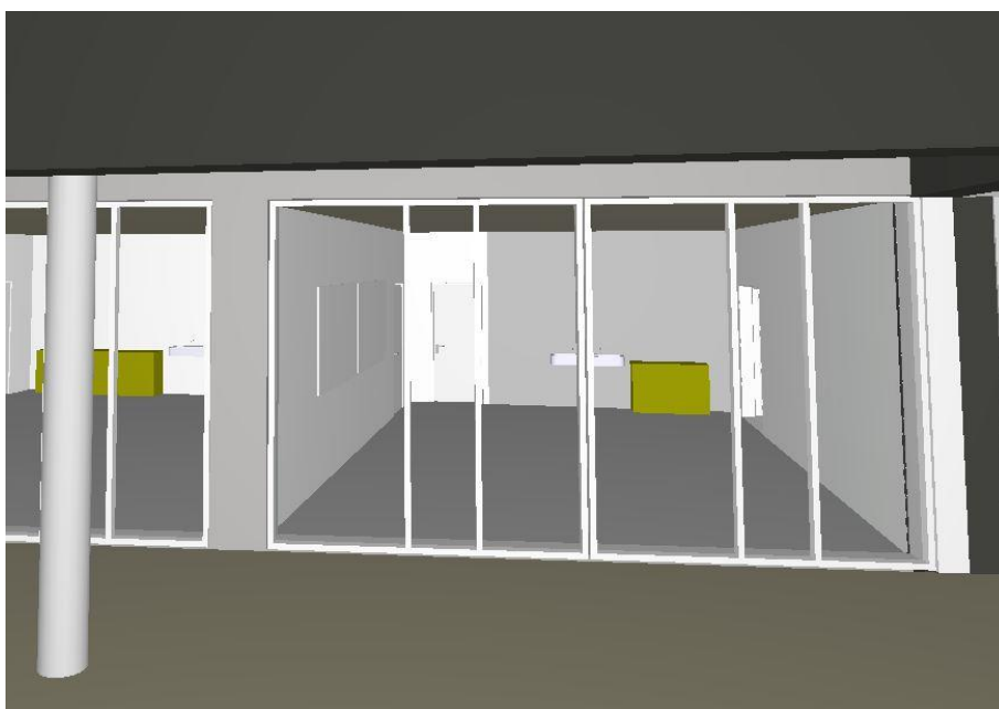
Figur 17 - Vinduer med lav brystning utløser krav til personsikkerhetsglass. Utklipp fra IFC-fil til ARK
