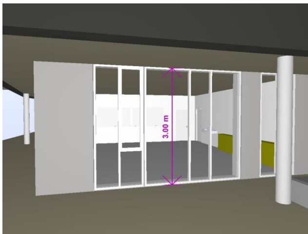
Figur 18 - Høye glassfelt i tilknytning i fasade til skoledelen. Høyde på glass måles her til 3,00 meter. Utklipp fra IFC-fil til ARK.
