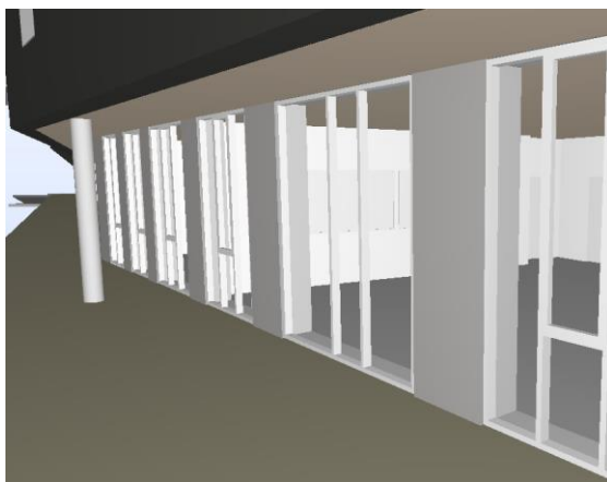
Figur 13 – Overgang yttervegg og ringmur (Utklipp fra IFC-fil)
