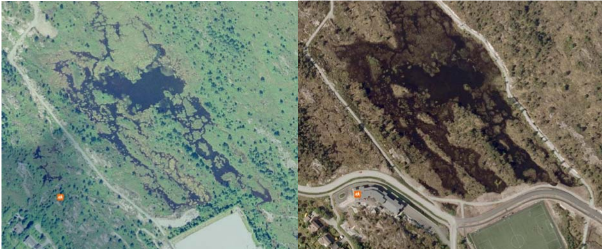
Figur 4-1: Flyfoto over Lonena. Det venstre bildet er tatt i 2003 og det høyre er tatt i 2009. Vannstanden er tydelig hevet, trolig på grunn av endret utløp.
