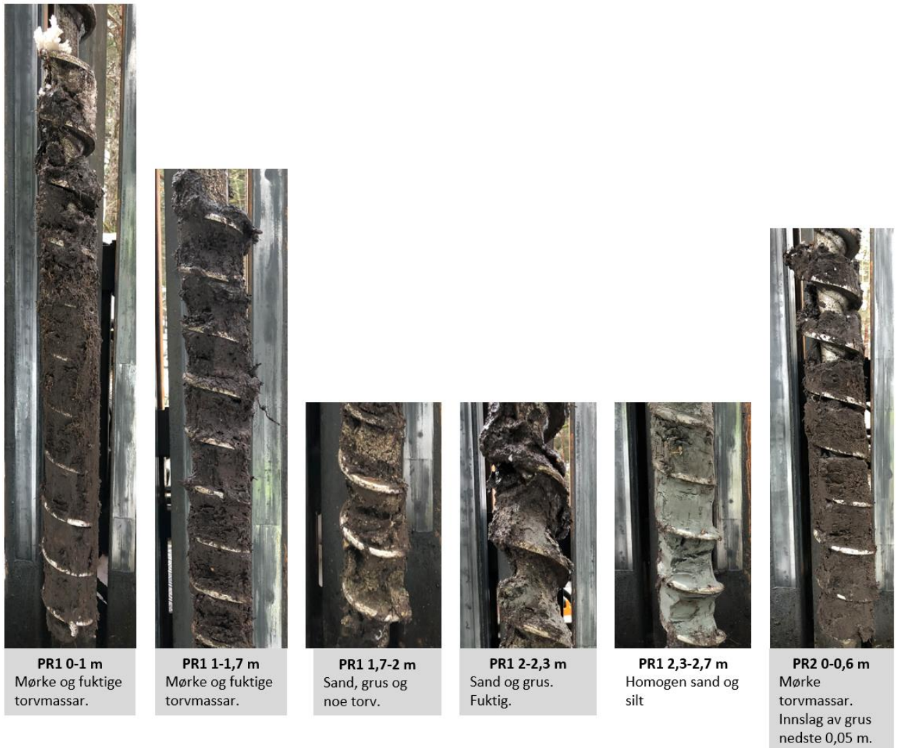
Figur 2-3: Bileta visar lausmassane som blei påtruffen i PR1 og PR2. Prøvar merka med grå bakgrunn blei sendt til analyse.
