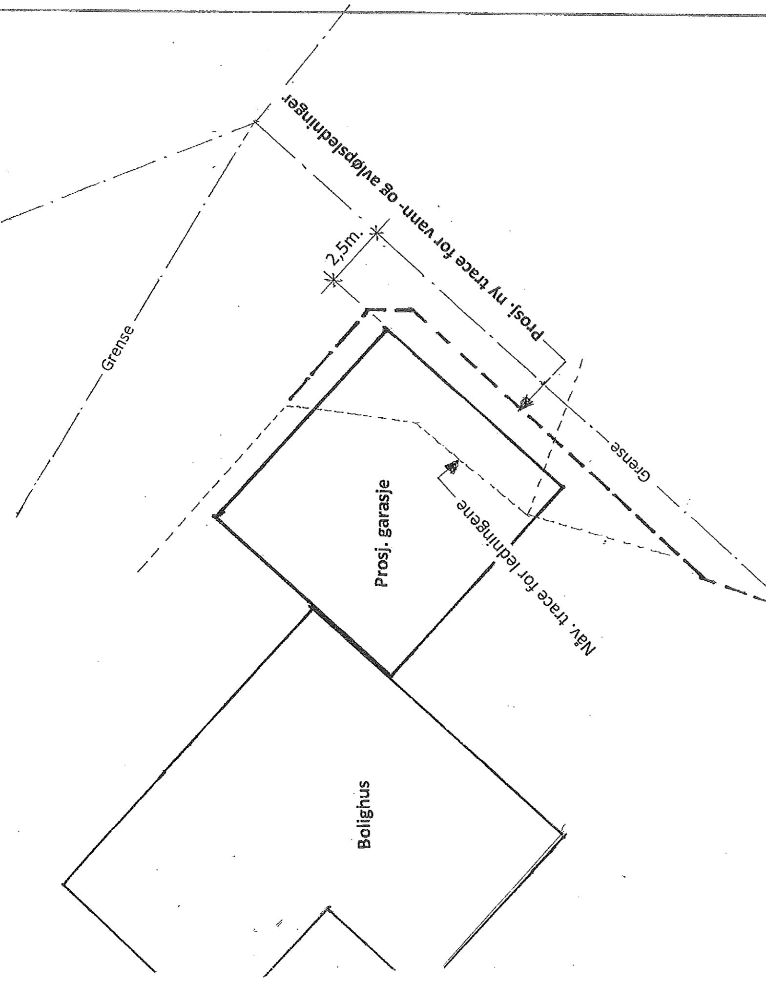
Ledningene legges i forskriftsmessige dybder i feltet mellom garasjen – og nabogrensen, som er ca. 2-2,5 m. mot eiendommen 108/284
