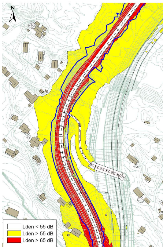
Figur 11: Støy fra ny lokalveg alternativ A, byggetrinn 2.
