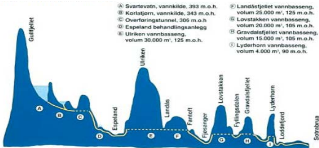
Fig. 4.1. Lengdeprofil av vannets vei fra kilde i Gullfjellet (Espeland vba.) til forbruker
