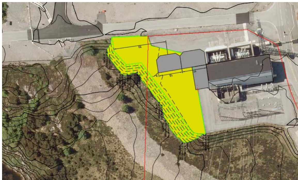
Figur 5 Utvidelse av transformatorstasjon på Kollsnes
