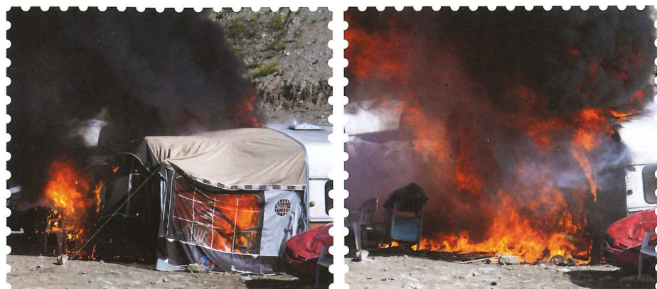
FIGUR 2: Tradisjonelle fortelt brenner også godt. Mange fortelt er fylt med møbler i plast og polyuretanskum som bidrar til et raskt og intenst brannforløp.
