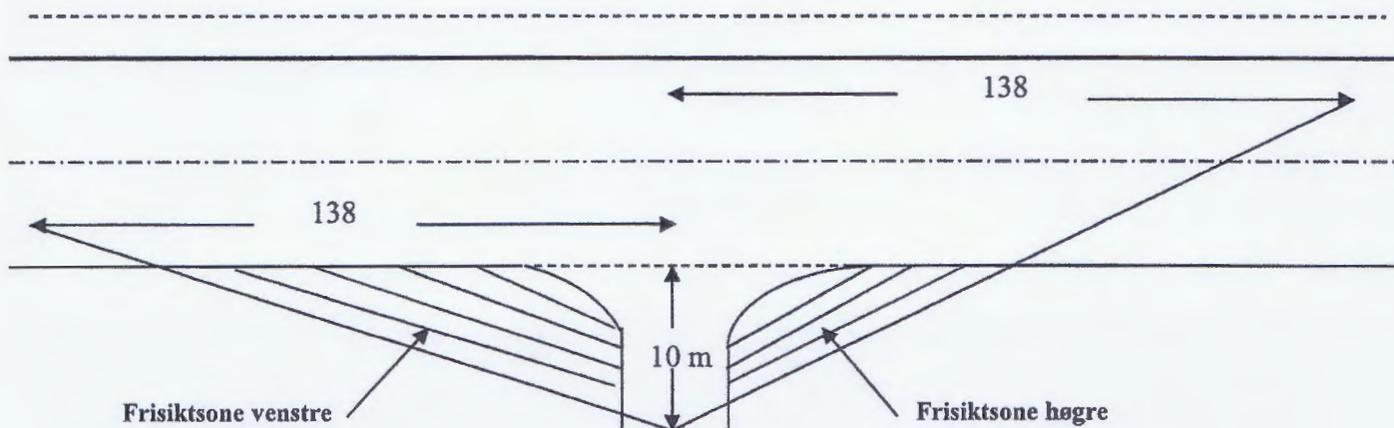
Tilsvarende siktlengder som vist på tegningen må også gjerast gjeldande for trafikken som kjem på hovedvegen og skal inn i avkjørsla (sikt bakover og framover langs hovedvegen)
