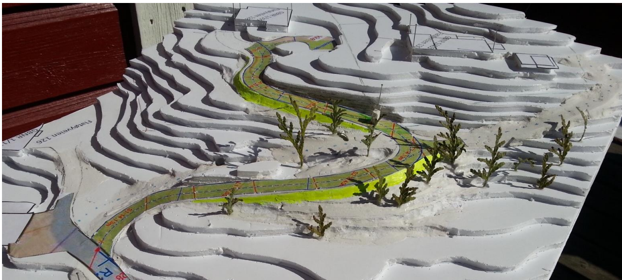
Fig.6: Tilkomsvei - veifylling i skogkledd terreng, beplantet som eksisterende terreng.
