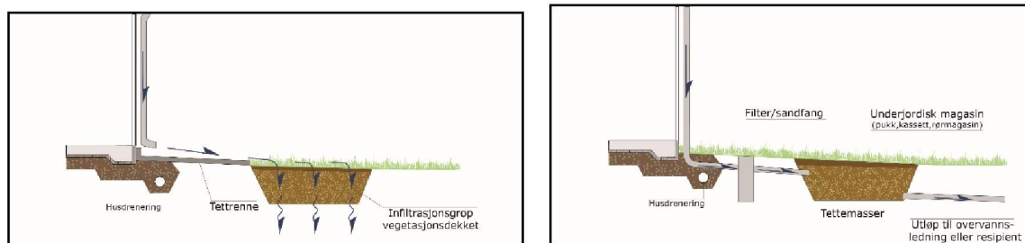
Figur 2 - Infiltrasjonsløsninger for takvann på arealer med permeable og tette jordmasser (III. COWI)
